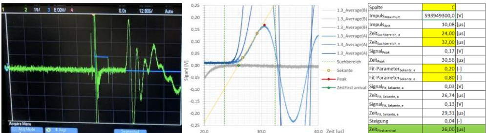
Ziel der Arbeit ist es, mit Hilfe der Software MatLab ein Programm zu entwickeln, mit welchem die anfallenden Messdaten aus Ultraschallmessungen an Asphaltprobekörpern automatisch weiterverarbeiten und analysiert werden können. Das Programm soll bestimmte Zeitpunkte in den Daten identifiziert werden können die dann im folgenden als Grundlage verschiedener Berechnungen dienen. Außerdem soll das Programm unterschiedliche Eingabemöglichkeiten besitzen, um die Auswertung anpassen zu können.
